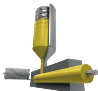
La tecnologia Smart Yarn consiste nel rivestire i filati di poliestere ad alta tenacità con un polimero, tesserli e stabilizzarli per ottenere prodotti con un'eccellente resistenza meccanica e ai raggi UV.
